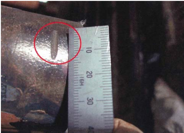
チューブ切断時につけた グラインダー傷
